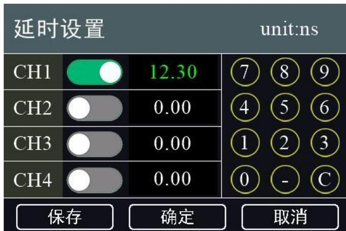
在这个界面，把某个探头对应的通道的选择按钮点亮(变成绿色)，然后用右边的数字区输入延时时间(单位是 ns)，最后点“保存”或者“确定”按钮即可。“保存”按钮代表把延时设置保存到硬盘，下次开机还可以使用。“确定”按钮代表延时设置仅仅本次有效，下次开机后无效。
